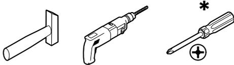
**\* VORSICHT:** Bei Verwendung eines Akkuschraubers (nicht empfohlen) möglichst niedrige Drehmomentstufe wählen!
